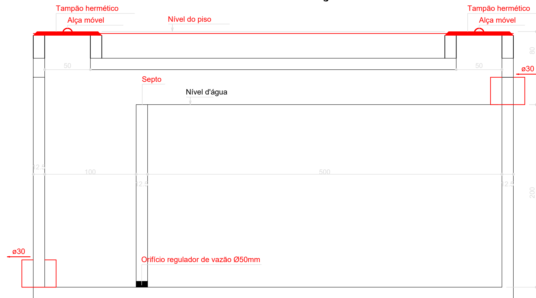
CAIXA DE RETENÇÃO CORTE - SEM ESCALA
