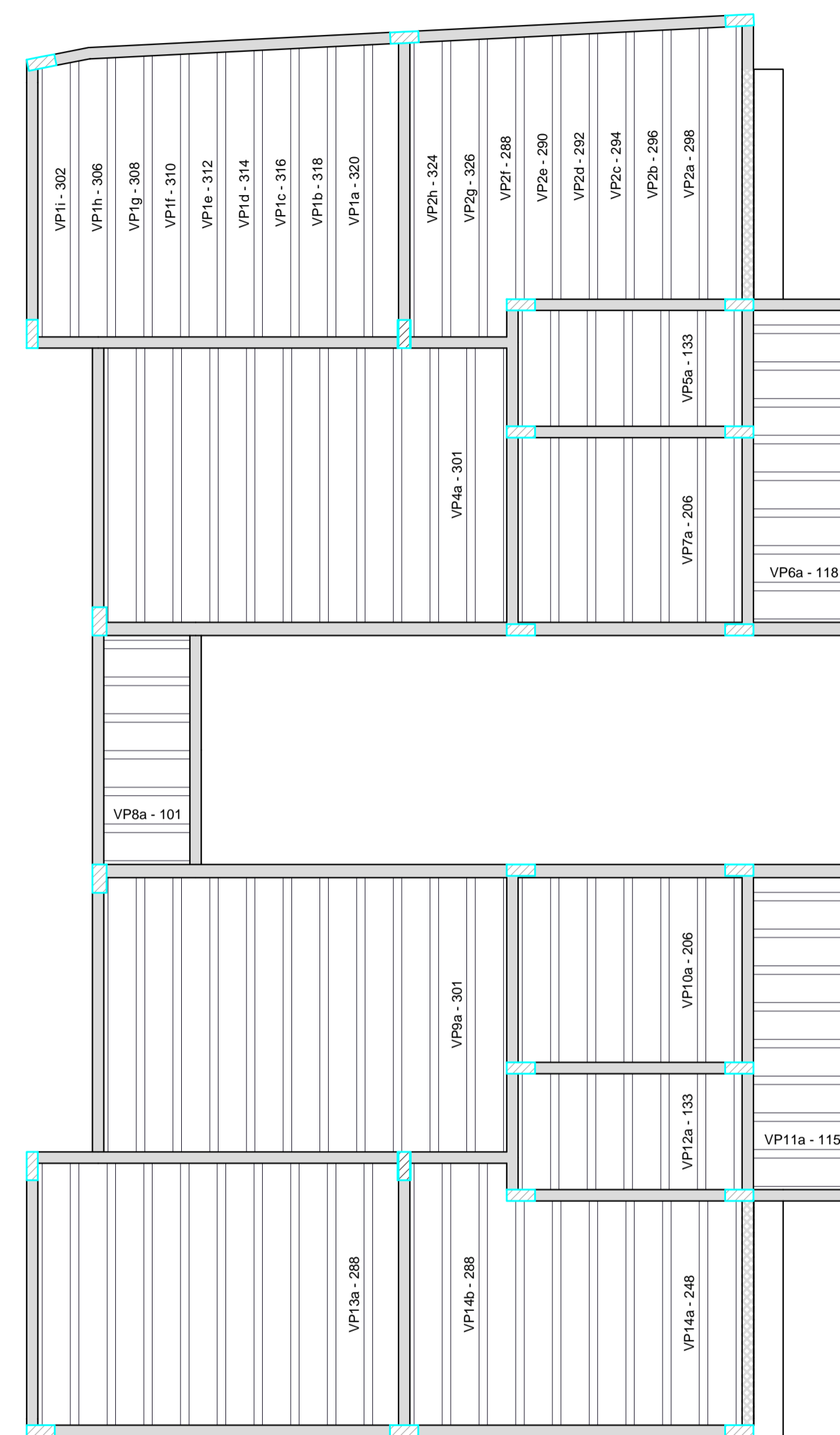
Planta de vigotas pré-moldadas escala 1:50
